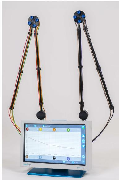
Mit dem Précise 8008 können Sie bis zu acht Messungen gleichzeitig durchführen und auf dem grossen Display alle relevanten Daten ablesen. Die Messwerte lassen sich grafisch wie numerisch darstellen. Die Sensorparameter, der Messverlauf sowie die Messergebnisse lassen sich auf einer SD-Karte speichern. So können Sie jede Messung dokumentieren und auch extern am PC bearbeiten.
