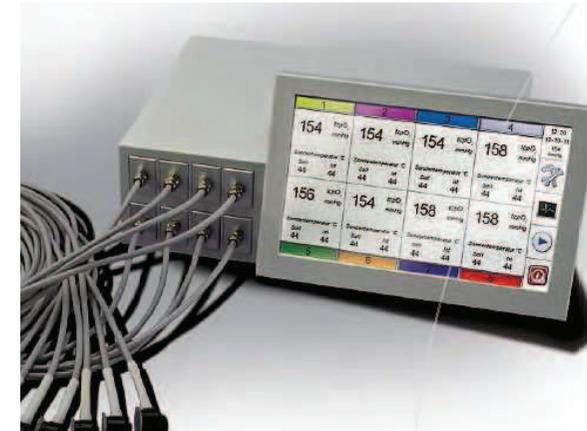
Mit dem Précise 8008 können Sie bis zu acht Messungen gleichzeitig durchführen und auf dem grossen Display alle relevanten Daten ablesen. Die Messwerte lassen sich grafisch wie numerisch darstellen. Die Sensorparameter, der Messverlauf sowie die Messergebnisse lassen sich auf einer SD-Karte speichern. So können Sie jede Messung dokumentieren und auch extern am PC bearbeiten.
